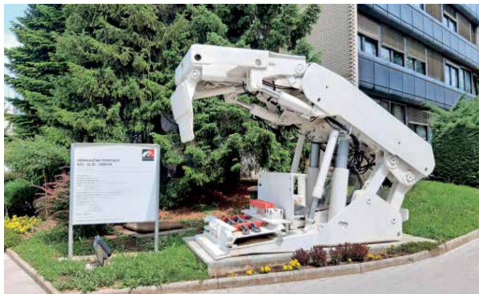
■ Muzejska predstavitev hidravličnega podporja, kakršnega so uporabljali v premogovniku.
