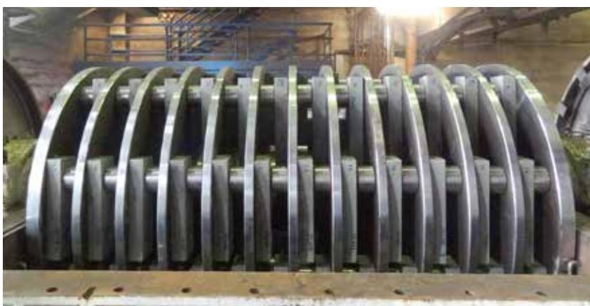
Novi rotor v drobilniku pred obnovo in po njej. (foto: Slavko Gros)
